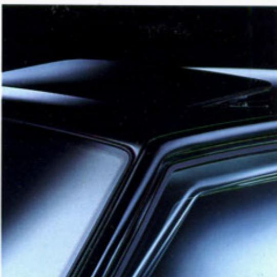
Das elektrisch verstellbare Schiebe-/Hebedach.
