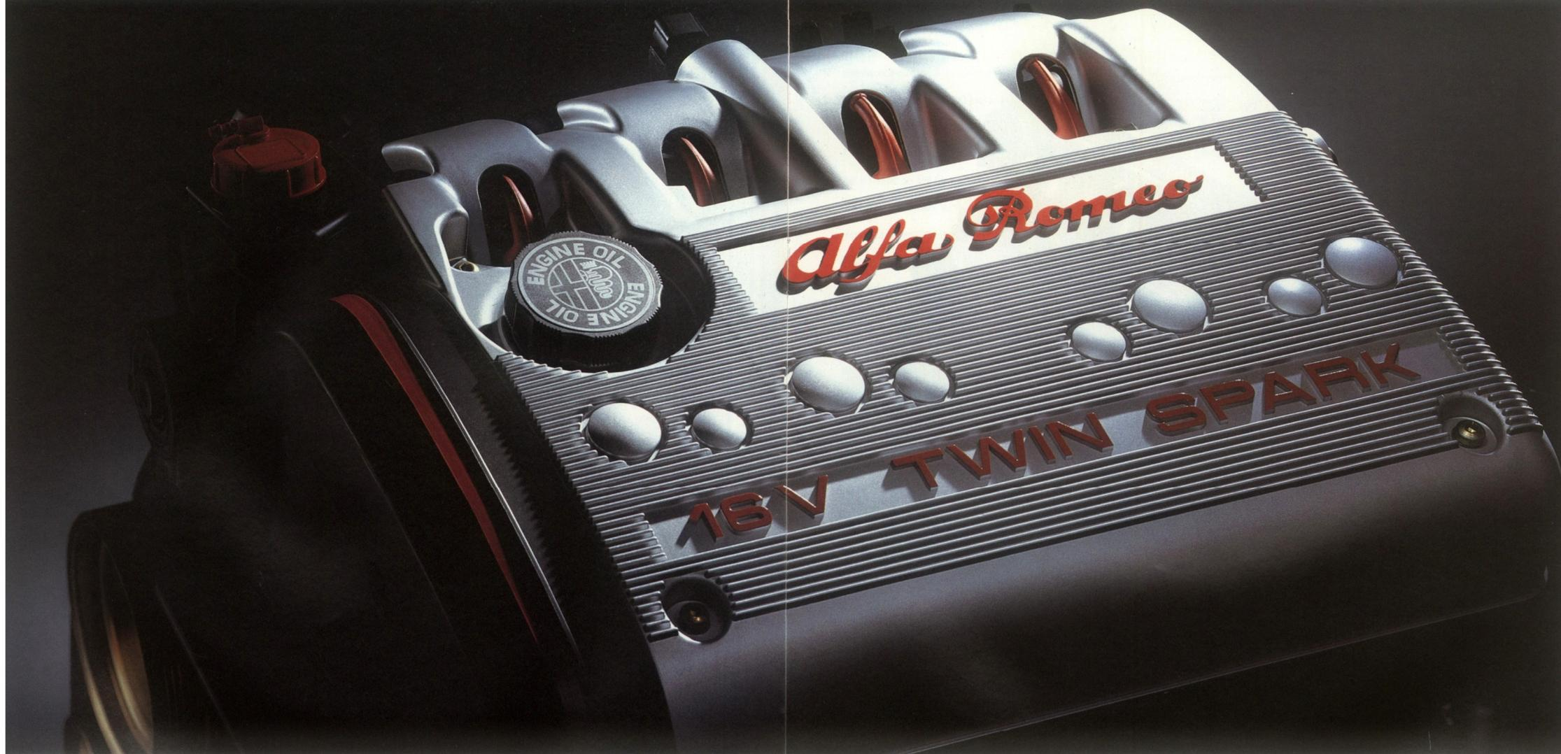
*Twin Spark bedeutet Doppelzündung: zwei senkrecht und parallel zueinander angeordnete Zündkerzen pro Zylinder. Die zwei Zündfunken dieses Systems optimieren die Zündung des Kraftstoff-Luft-Gemisches. Das bringt Vorteile für die Leistungsabgabe des Triebwerkes und optimiert die Verbrauchs- und Emissionswerte, da der Kraftstoff vollständig verbrannt wird.*
