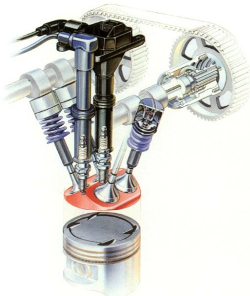
Twin Spark steht für Doppelzündung, d.h. zwei Zündkerzen pro Zylinder. Das bedeutet eine optimale Steuerung des Verbrennungsprozesses im Motor.
