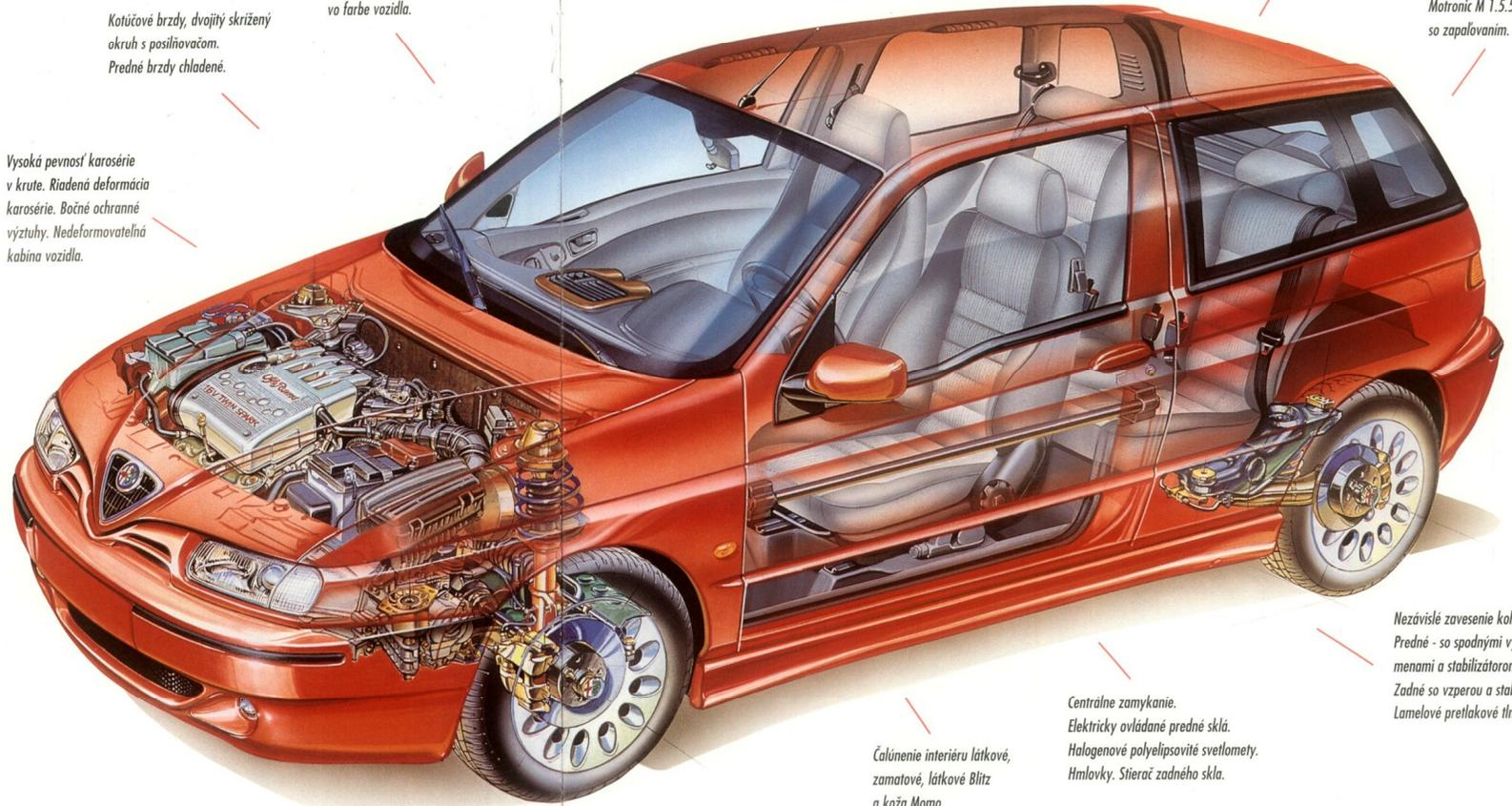
Nezávislé zavesenie kolies. Predné - so spodnými výkyvnými ramenami a stabilizátorom. Zadné so vzperou a stabilizátorom. Lamelové pretlakové tlmiče.
