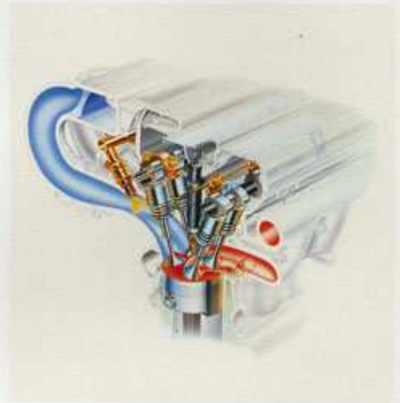
Modernste Vierventil-Technik mit zwei obenliegenden Nockenwellen
