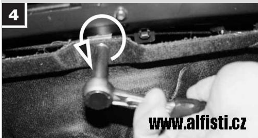
5. Svěšení filcu pod přihrádkou a ventilátorem
