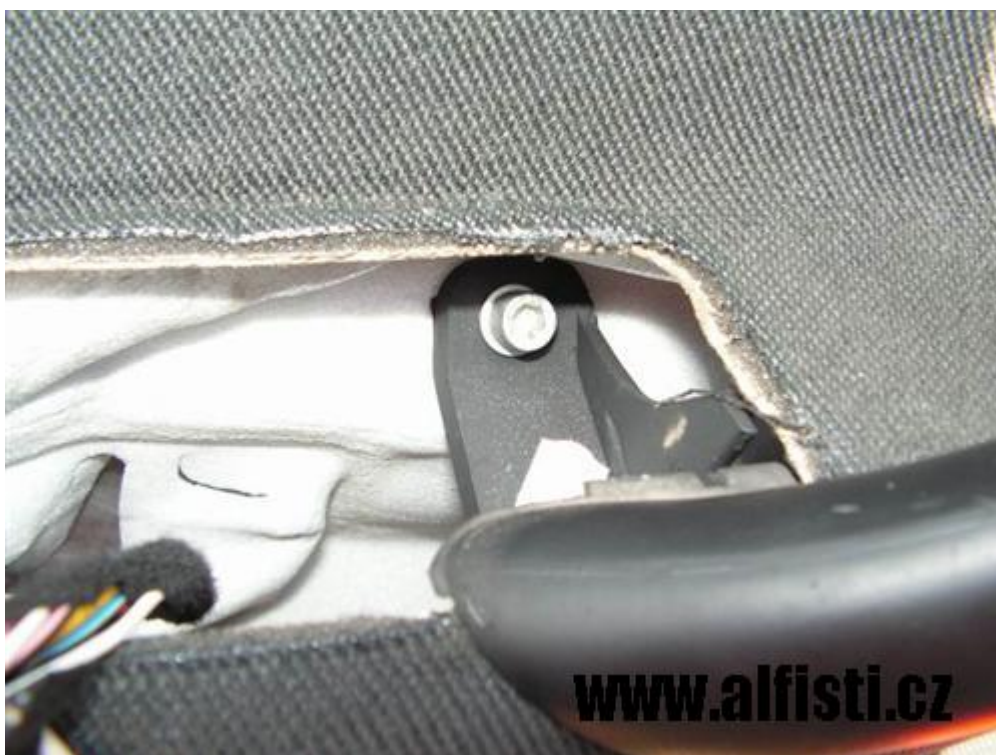
8) pohled na lampičku a první ze křížových šroubů 4. Ten demontujeme a lampičku opatrně vyjmeme. Pozor pro sundávání dveřního panelu je potřeba lampičku odpojit od elektroinstalace
