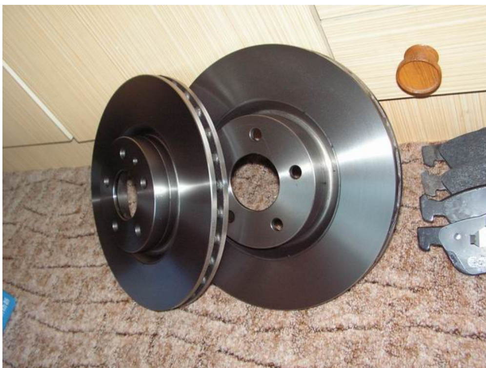
4) kotouče je před použitím potřeba odmastit. Kdybychom tak neudělali, asi bychom si moc nezabzdili. Já použil nitroředidlo. Jsou konzervované nějakým olejem, aby jim to nezrezlo, než to prodají.
