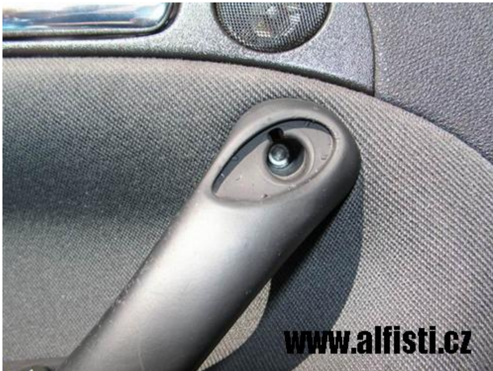
7) pohled na druhý ze šroubů 2 - ten je jinak schovaný pod panelem se spínači
