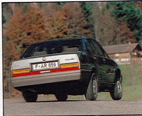
Obwohl das Getriebe an der Hinterachse liegt, bringt der Alfa seine Kraft schlecht auf den Boden. Speziell in engen Kurven läßt die Traktion zu wünschen übrig; beim Gasgeben dreht das kurveninnere Hinterrad leicht durch
