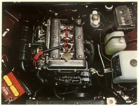
Der Motorraum der Giulietta ist geräumig. Die verschiedenen Aggregate sind bei Kontrollen und Reparaturen leicht zugänglich; dies bedeutet Kostenersparnis bei Wartungsarbeiten. Oben: zentraler Relais- und Sicherungskasten mit guter Zugänglichkeit im Motorraum.
